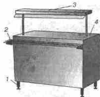
Рис. 11.21. Нейтральний прилавок: 1 — опора; 2 — бар'єр; 3 — полиця; 4 — отвір
